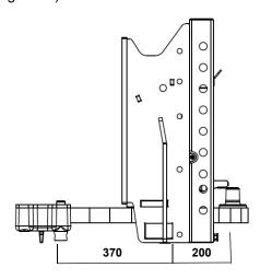
Die zulässige Auflagekraft an der Zugpendelauflage nach der Anlage 2 muss für die voranstehenden Kennwerte mindestens 90 kN betragen.
